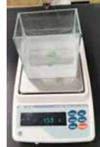
糸でつるして 水の中で重さを量る
